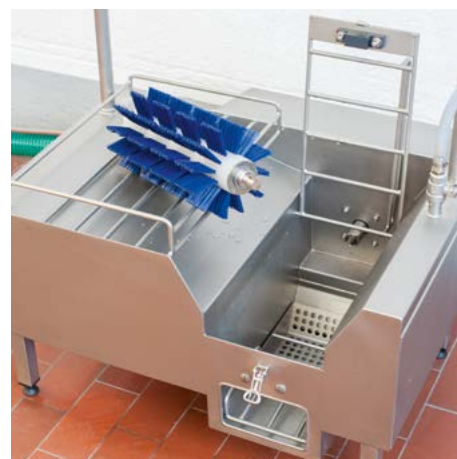
Cierre rápido de brida para facilitar la limpieza
